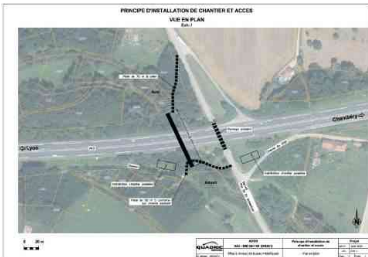
Figure 12 : Principe d'installation de chantier et accès
